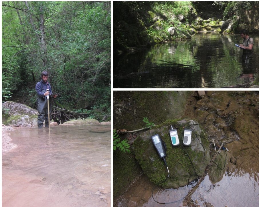
Fig. 3. Mesura del cabal al riu Ridaura (Esquerra). Presa de dades d'hàbitat fluvial i qualitat del bosc de ribera (Dreta, dalt). Sondes d'oxigen, pH i conductivitat (Dreta, baix).
